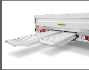
Aluminium-Bohlen (bis 1,9 t Tragkraft / Länge 2465 mm; bis 2,3 t Tragkraft / Länge 2230 mm; bis 2,8 t Tragkraft / Länge 2650 mm)
